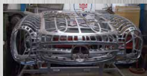
Costruzione manichino per rifacimento in alluminio parte anteriore Mercedes 300 SL Roadster
