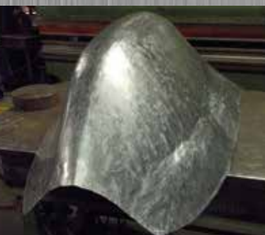
Ricostruzione cupolino posteriore auto Formula 3
