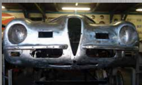
Ricostruzione musetto Alfa Romeo 2500
