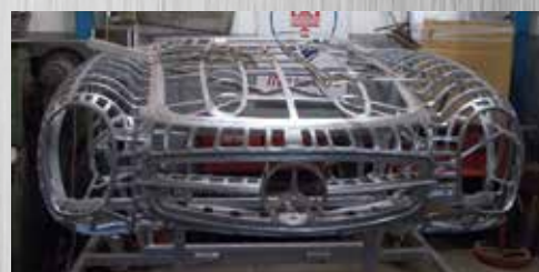
Costruzione manichino per rifacimento in alluminio parte anteriore Mercedes 300 SL Roadster
