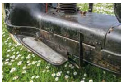
Il retrotreno è rigido. Il doppio freno fu introdotto con l'inizio delle importazioni in Europa e della costruzione su licenza nel Regno Unito.
