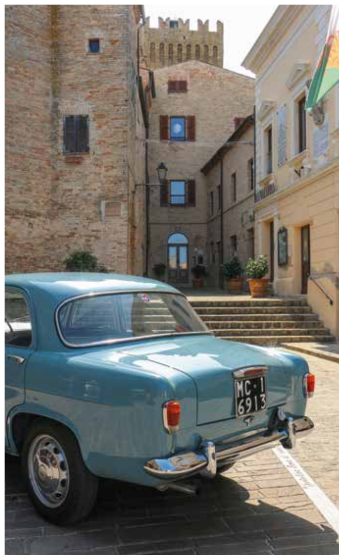
Fra gli espedienti la coda con accenno di pinne, che raddrizza visivamente uno specchio massiccio, necessario per ospitare le sospensioni dall'ampia escursione fortemente volute da Ivo Colucci e Giampaolo Garcea. Caratteristica la posizione del tappo carburante, a destra alla base della targa.
