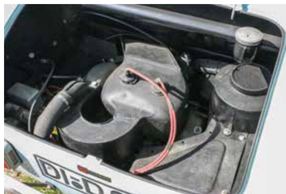
La maniglia per attivare il miscelatore, in una posizione curiosa, alla base dello schienale della panchetta posteriore. Sotto, il motore di 250 cm 3 con l'airbox installato.
