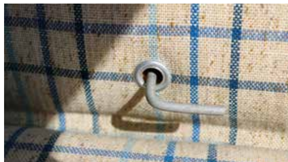
La maniglia per attivare il miscelatore, in una posizione curiosa, alla base dello schienale della panchetta posteriore. Sotto, il motore di 250 cm 3 con l'airbox installato.
