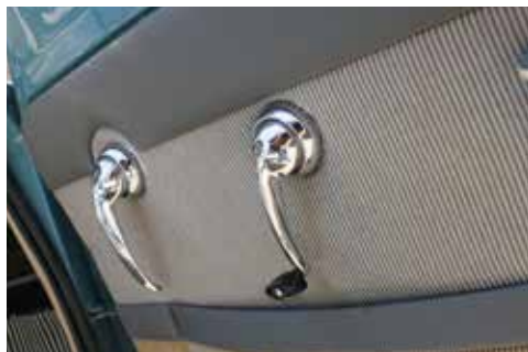
Il pannello laterale con la maniglia di apertura e la manovella apertura vetro. Si può notare la finitura originale della tappezzeria grigio rigato.
