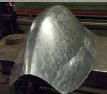
Ricostruzione cupolino posteriore auto Formula 3
