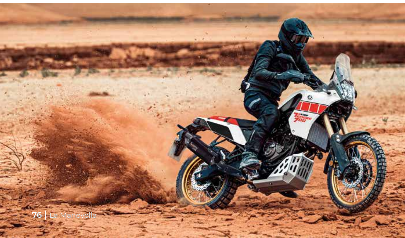
La Ténéré 700 (TZ) attuale, dotata di un bicilindrico parallelo, qui in configurazione World Rally e tinta “White Heritage” che riprende quella della 34L del 1983.
