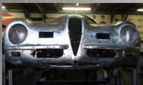
Ricostruzione musetto Alfa Romeo 2500
