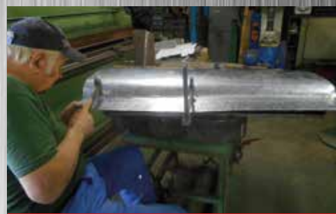
Costruzione fodero portiera in alluminio
