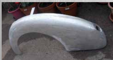
Costruzione in alluminio parafrango posteriore Lancia Aprilia cabriolet
