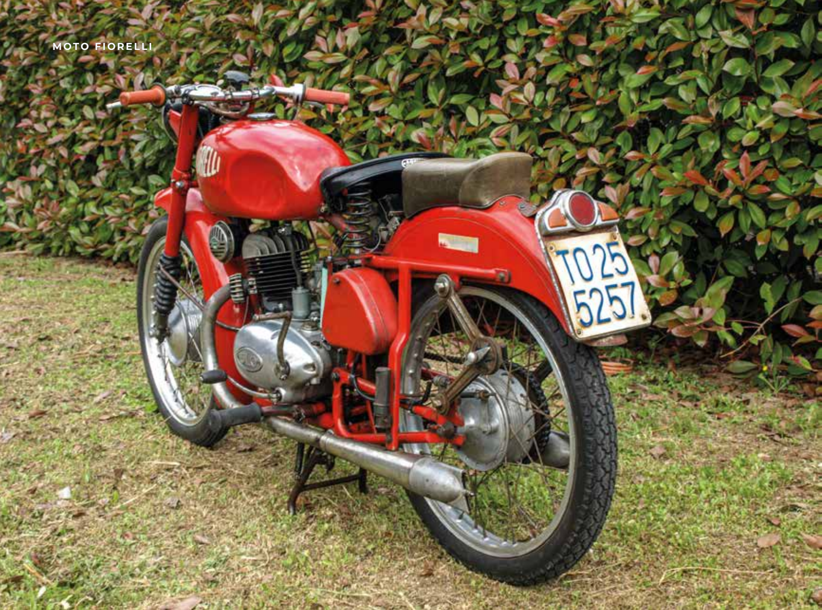
Nella parte posteriore si può notare il particolare telaio a tubi e il doppio scarico. Sotto, una rara foto dell'epoca di un ciclomotore della Casa piemontese.
