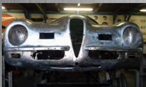
Ricostruzione musetto Alfa Romeo 2500
