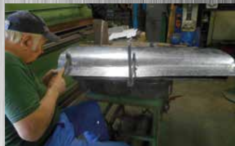
Costruzione fodero portiera in alluminio
