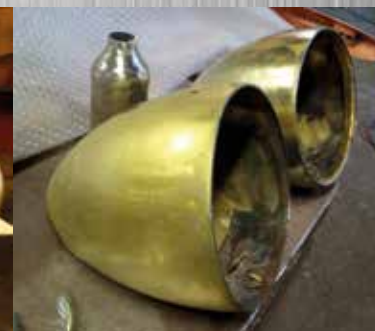
Ricostruzione in ottone sede fanali per Lancia Aprilia
