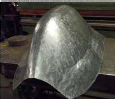
Ricostruzione cupolino posteriore auto Formula 3
