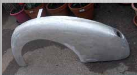
Costruzione in alluminio parafrangente posteriore Lancia Aprilia cabriolet
