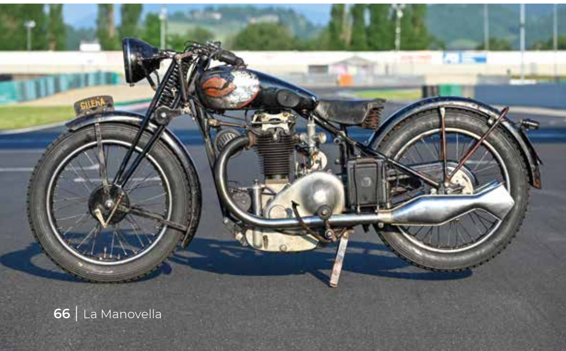
Sopra, il manubrio con il frenasterzo sulla forcella a parallelogramma, il serbatoio da 12 litri, che da catalogo poteva essere sostituito con uno da 18 litri, e il faro Bosch.
