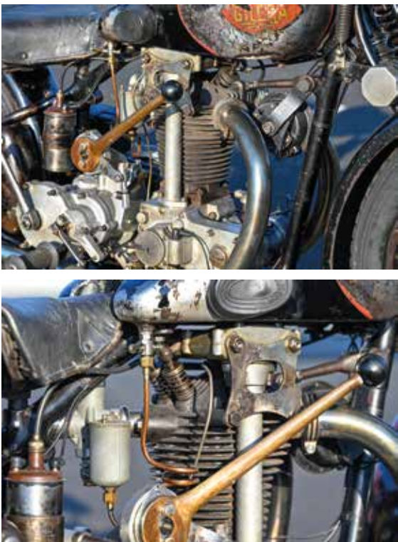
Le due foto consentono di vedere la singola valvola di scarico anteriore e le due di aspirazione. Quest'ultime sono azionate da un unico bilanciante a due bracci. I bilanciamenti sono comandati da 2 aste che scorrono in un tubo di protezione esterno al lato destro del cilindro.
