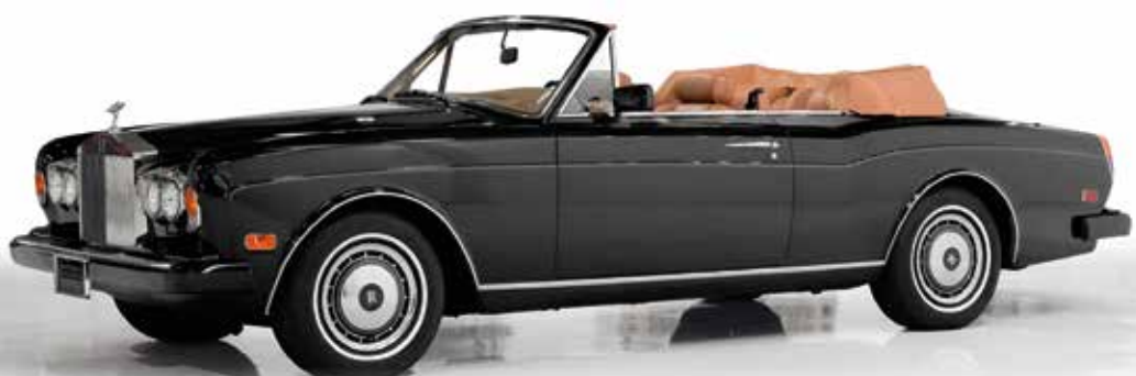
Una Corniche degli anni '80 con motore di 6,75 litri e paraurti con inserto plastico, elementi tipici della Silver Shadow II introdotta nel 1977. La scomparsa del modello coupé rende superflua la sigla "Convertible".
