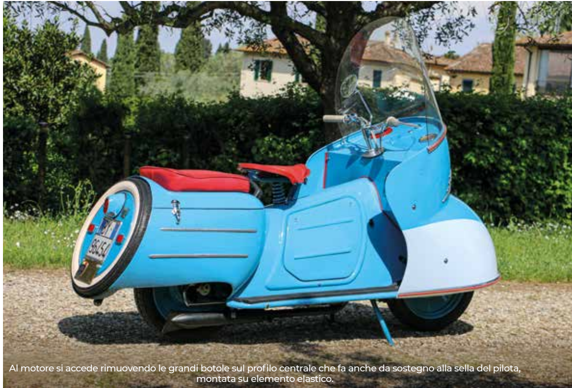
Nella vista posteriore balza all'occhio la ruota di scorta piazzata trasversale e annegata nella carenatura, il cui pannello centrale fa anche da porta-targa.
