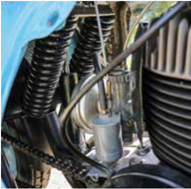
Il filtro aria, il carburatore Bing e la particolare sospensione posteriore, con il motore elemento elastico, l'ammortizzatore montato a rovescio e le due lunghe molle elicoidali. Particolare del terminale di scarico e della trasmissione secondaria - come la prima - a catena.
