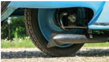
Il filtro aria, il carburatore Bing e la particolare sospensione posteriore, con il motore elemento elastico, l'ammortizzatore montato a rovescio e le due lunghe molle elicoidali. Particolare del terminale di scarico e della trasmissione secondaria - come la prima - a catena.
