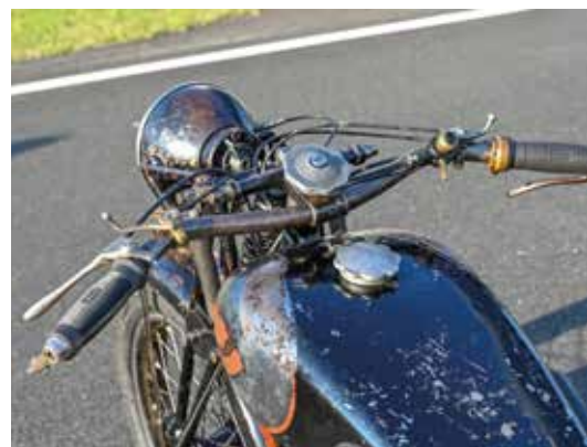
Sopra, il manubrio con il frenasterzo sulla forcella a parallelogramma, il serbatoio da 12 litri, che da catalogo poteva essere sostituito con uno da 18 litri, e il faro Bosch.
