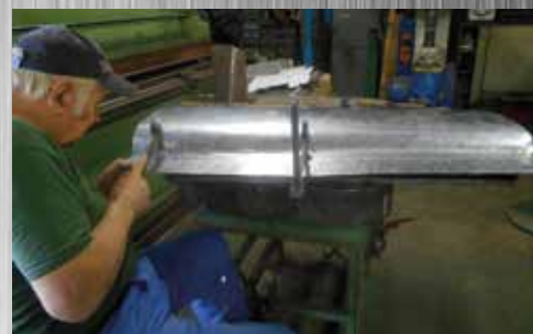
Costruzione fodero portiera in alluminio
