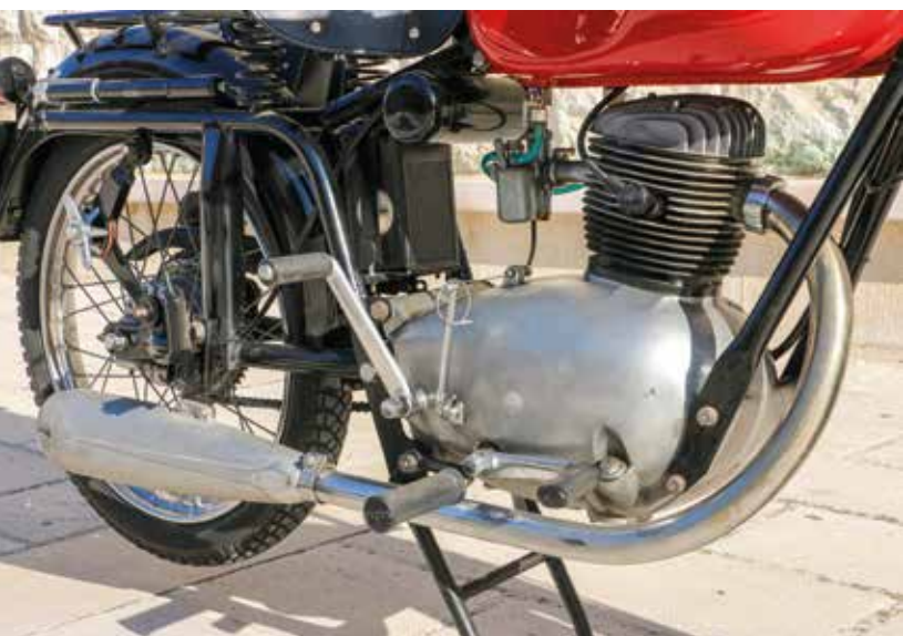
Il motore 150 ha cilindro in ghisa con testa in lega leggera e struttura inferiore a doppio semicaratter liscio, quello di destra fisso, quello sinistro in foto amovibile, per evitare i trafilaggi. La vista del motore da destra, col semicaratter fisso. Sotto, la sospensione posteriore a pantografo.
