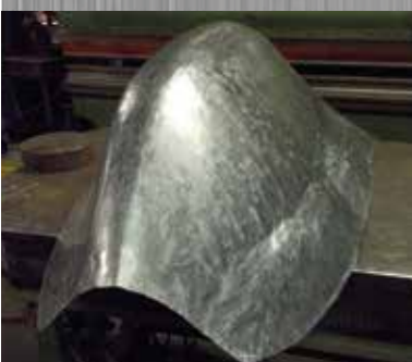
Ricostruzione cupolino posteriore auto Formula 3
