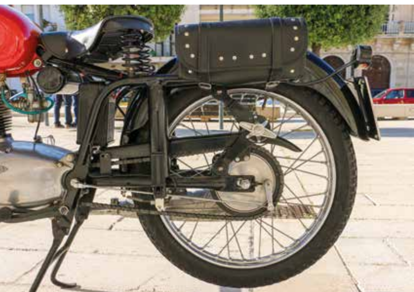
Il motore 150 ha cilindro in ghisa con testa in lega leggera e struttura inferiore a doppio semicaratter liscio, quello di destra fisso, quello sinistro in foto amovibile, per evitare i trafilaggi. La vista del motore da destra, col semicaratter fisso. Sotto, la sospensione posteriore a pantografo.
