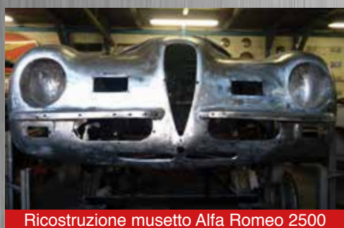
Ricostruzione musetto Alfa Romeo 2500
