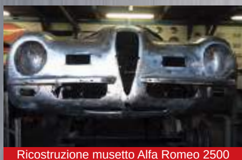
Ricostruzione musetto Alfa Romeo 2500
