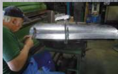
Costruzione fodero portiera in alluminio
