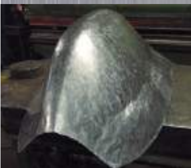
Ricostruzione cupolino posteriore auto Formula 3
